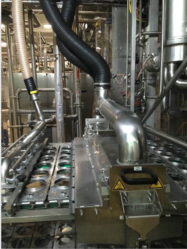
Becher- und Deckelentkeimung in Rundläufermaschine
