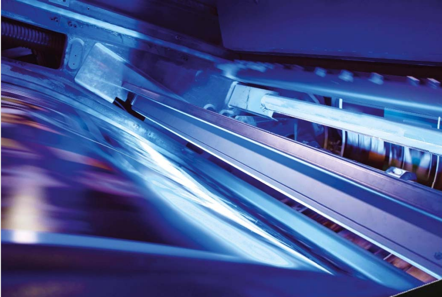
LED-Modul auf einer Bogenoffsetmaschine
