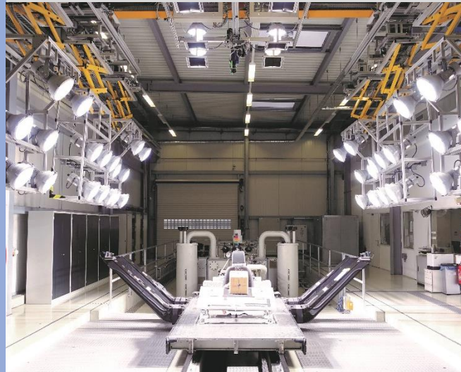
Komplexe mechanische Aufbauten zur Aufnahme unser UV-Strahler für die Sonnensimulation
